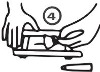
Appliquez de la colle sur le panneau et le patch en utilisant une brosse ou un autre applicateur. Assurez-vous que la colle est répartie uniformément et complètement sur la planche et le patch. Laissez sécher la colle pendant 5min.
