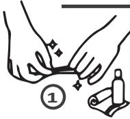
Nettoyez la zone autour de la coupure ou de la ponction en utilisant de l'acétone ou M.E.K.
